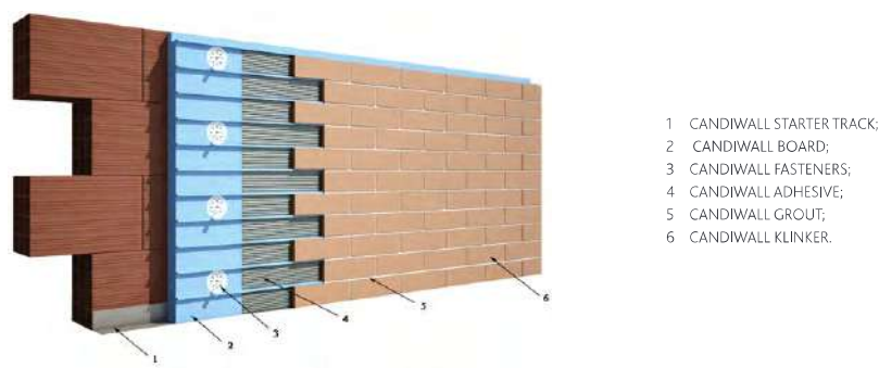
Figura II.1 – Pormenor geral do sistema CANDIWALL
